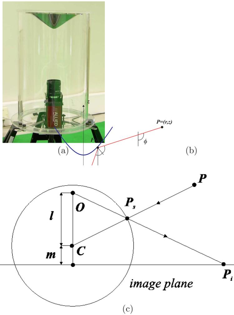
Figure 1: (a) Telecamera omnidirezionale catadiottrica. (b) Il generico modello di proiezione catadiottrico: Catadioptric Projection Model. (c) Il modello di proiezione per telecamere centrali: Unified Projection Model.
