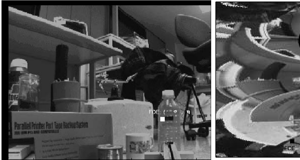
Fig. 6.5: Transformação log-polar numa imagem da Sequência 3. À esquerda, a imagem em coordenadas cartesianas e, à direita, a mesma imagem em coordenadas log-polares.
