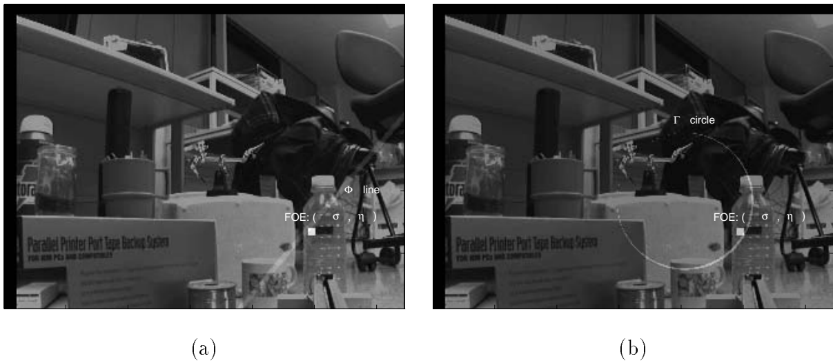
Fig. 5.9: Resultados da estimação através do (a) algoritmo de procura da recta- \Phi e do (b) o algoritmo de procura da circunferência- \Gamma , aplicados à Sequências 3.
